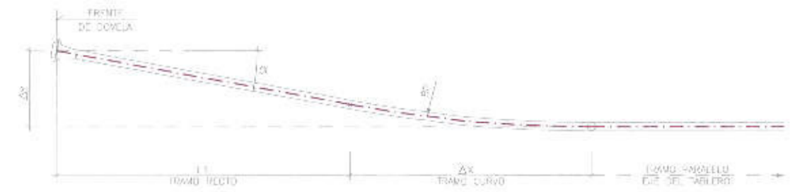
ESQUEMA DESPLAZAMIENTO EN PLAN A (PRETENSADO TIPO B) (TENDONES 5 A 12) 5/ESCALA
