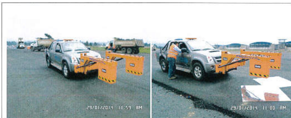
Figura 6 Antenas de 1 Ghz y 2 Ghz generadoras de impulsos dieléctricos, instalados en vehículo
