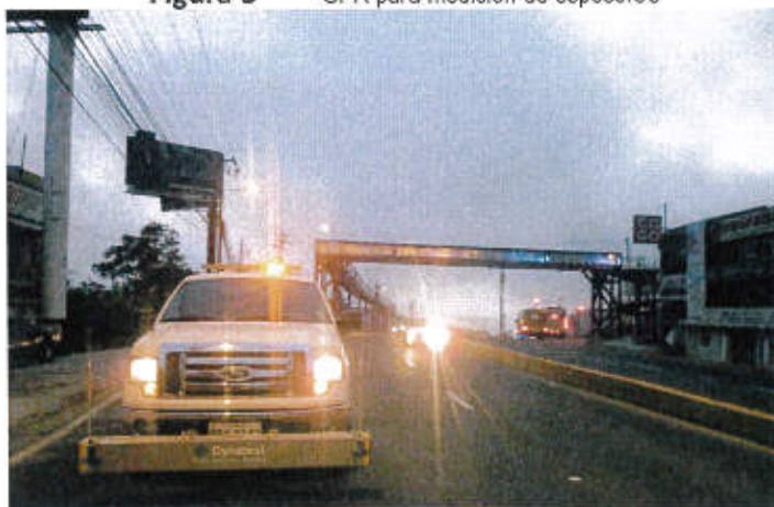
Figura 4 RSP para medición de IRI Figura 5
